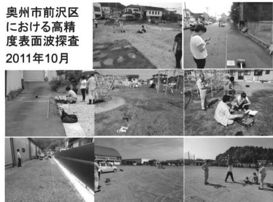
↑余震で被害を受けた奥州市前沢区における地盤探査風景（高精度表面波探査）。
